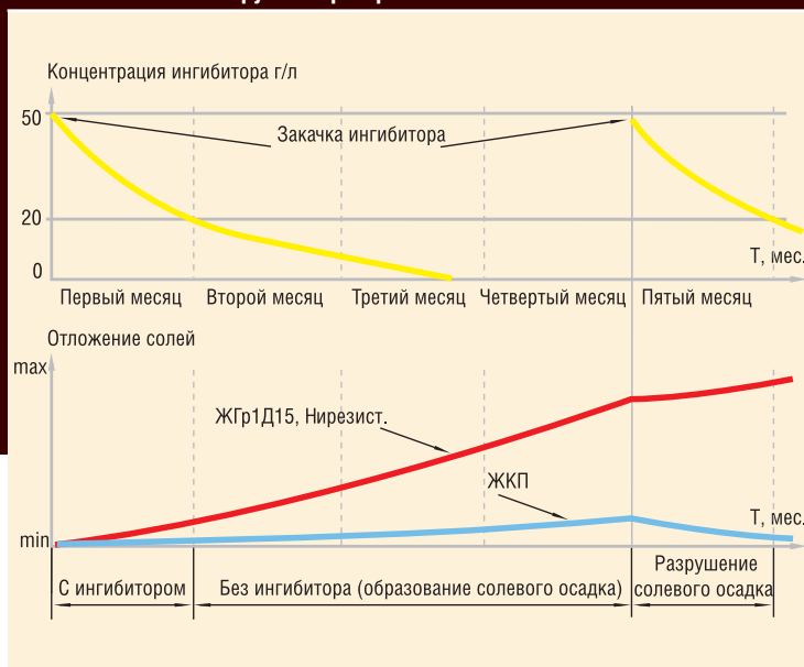
Рис. 1. Метод «прерывной обработки» скважин подачей ингибитора солеотложения в затрубное пространство
