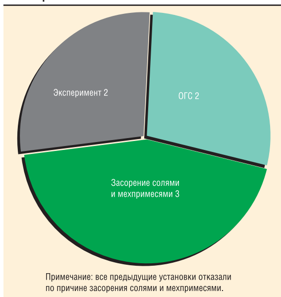
Рис. 4. Причины отказов оборудования производства «Ижнефтепласт» по ОПИ № 01-ПМ-2008
